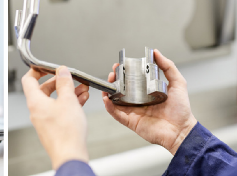
Pulvérisateur avec canaux de chauffage internes
