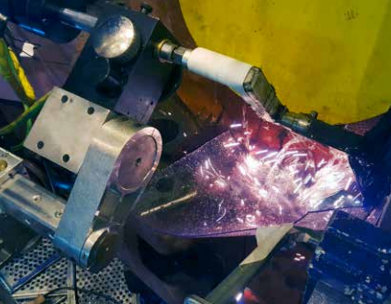
Vonkersie om bouten, tappen en hardmetalen stukken van machines te verwijderen.
